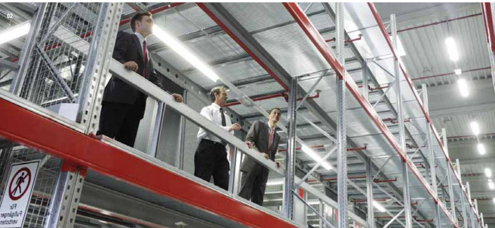
01 Das Herzstück: In der Fachbodenregalanlage HI280 arbeiten auf 10.000 m 2 Laufgängen bei voller Auslastung 8 Mitarbeiter pro Turm und Ebene.
