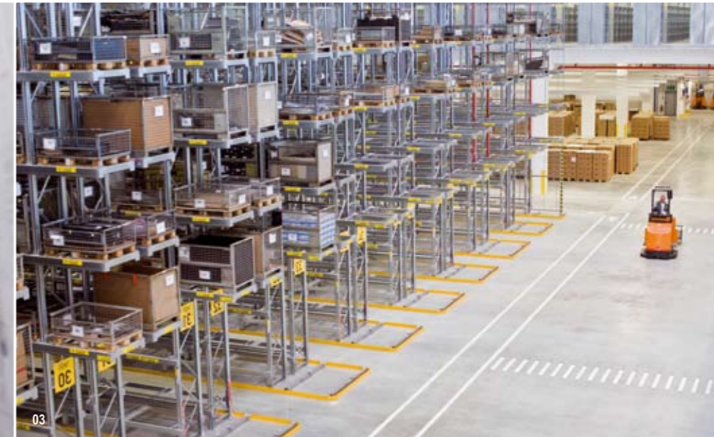
01 Im Zentrum des Lagers: eine Verschieberegalanlage für Ladungsträger bis 2,6 m Länge.
