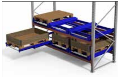
Palettenauszüge mit einer Auszugslänge von 62 - 100 % Vollauszug
