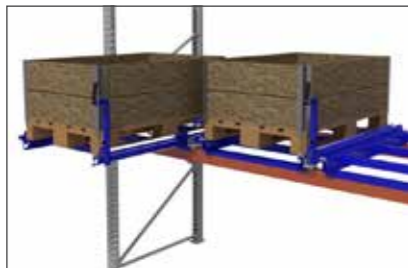
Palettenauszug mit seitlich integriertem, ergonomischen Handgriff
