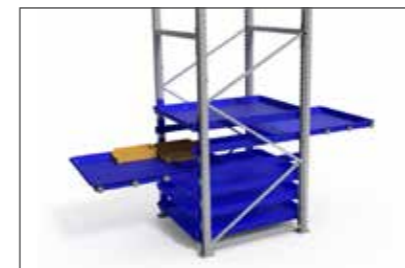
Doppel- oder Einzelauszugsboden mit nur 6 mm Bauhöhe und 60 mm Aufkantung um den Auszugsboden
